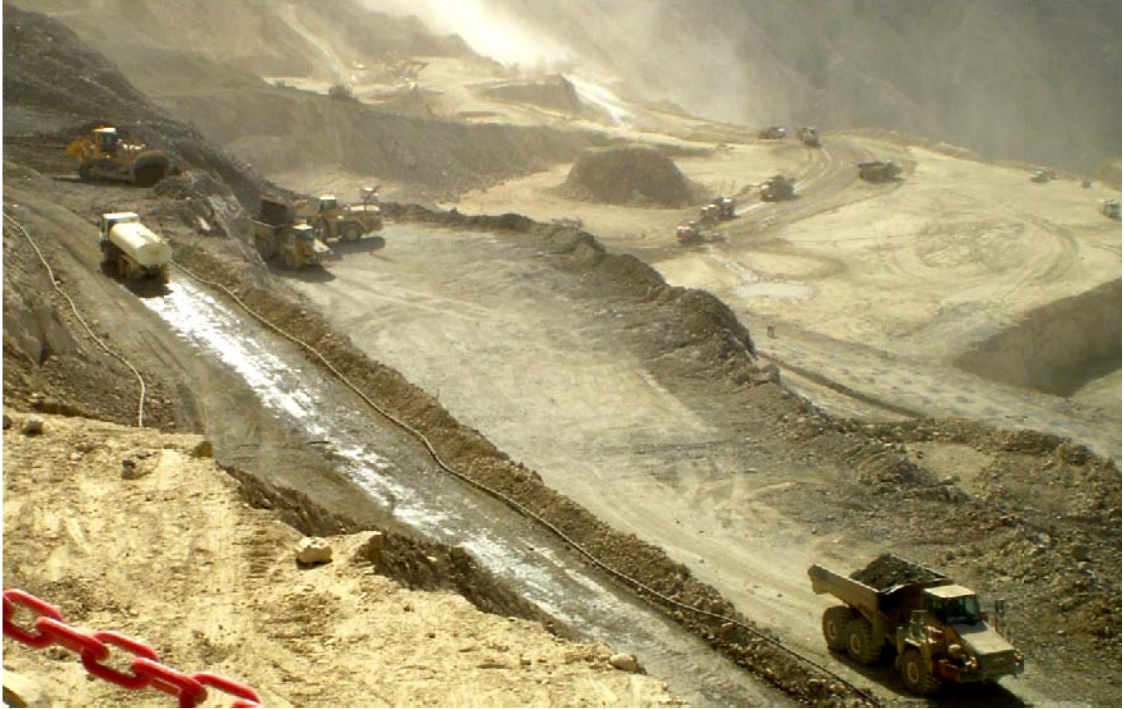
Ilustración 7 Carga de camiones con palas
