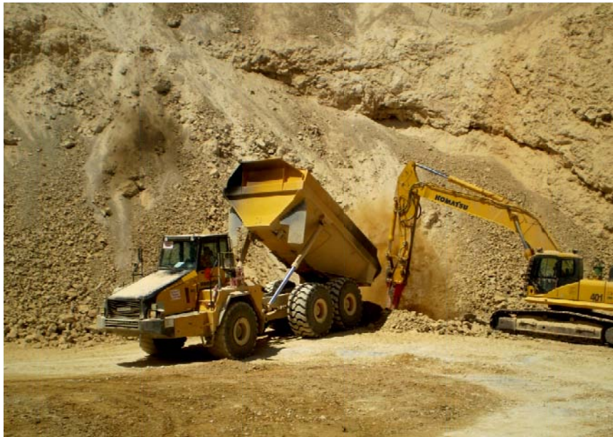
Ilustración 10 Descarga de mineral en el orepass
