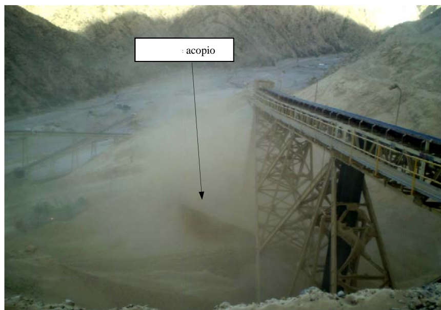
Ilustración 14 Volcado de cinta transportadora a la pila de almacenamiento
